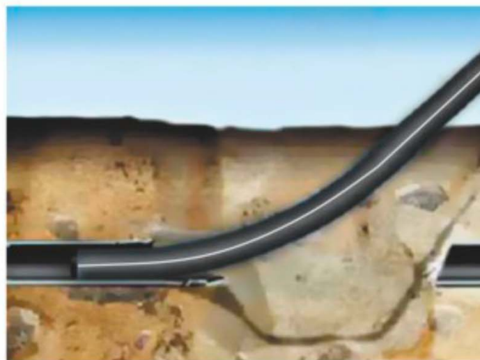
Релайнинг(протаскивание трубы в трубу)
