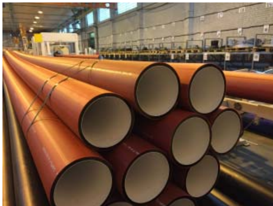
Термостойкость «ПРОТЕКТОРФЛЕКС» сохраняется до 110°C (Протокол испытаний №1203/0815 от 26.08.15 ИЛ «ГОСТЭКСПЕРТСЕРВИС»)
